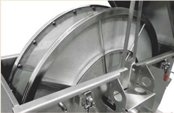
Abb. 2 Standardausführung eines rotierenden Siebfiltermoduls mit seinem Radpaar und den Filterflächen
