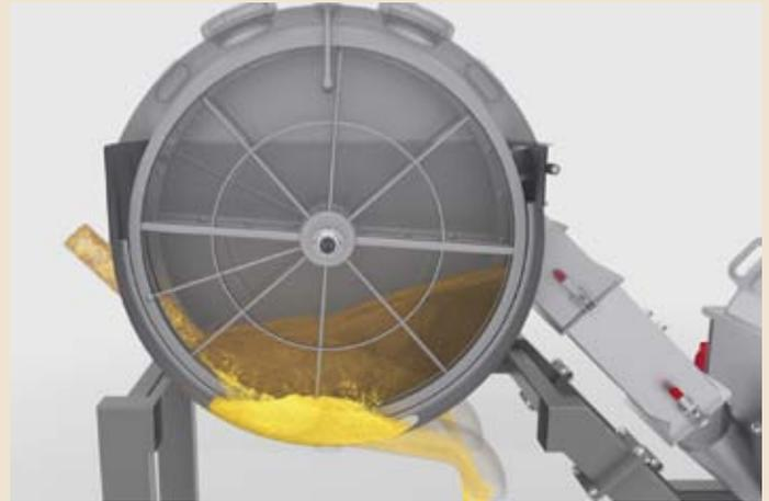
Abb. 3 Würze- und Treberseparation finden in den Modulen am unteren Kreissegment des Filtersiebs statt
